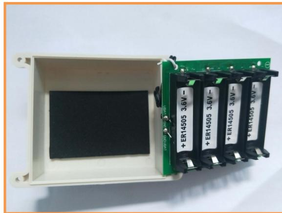
图二 电池 PCB 板反面
