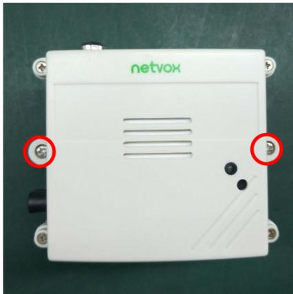
2. 环境感应器——温湿度\_PM2.5(R72616A)的电池盒采用内装锂电池方式，需要将电池盒四个角的外壳螺丝拧开。将8节 ER14505 3.6V 电池装入电池槽，正面4节，反面4节。装入电池后，将电池 PCB 板按正面朝上，安装到外壳上盖。如图一。
